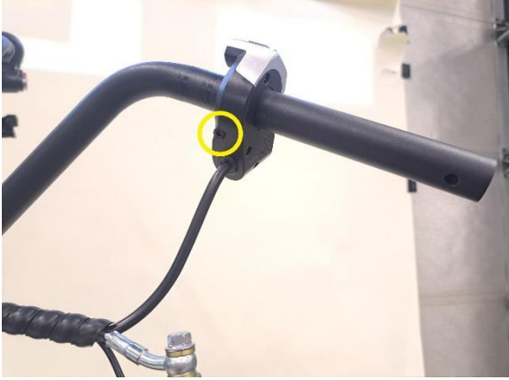
Löysää vasemman kahvarungon kiinnityspulttia (kuusiokoloavain 3 mm).
