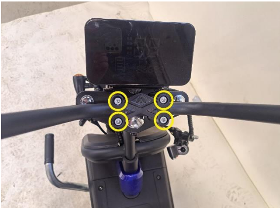
Irrota ohjaustangon kiinnityspultit (kuusiokoloavain 6 mm).
